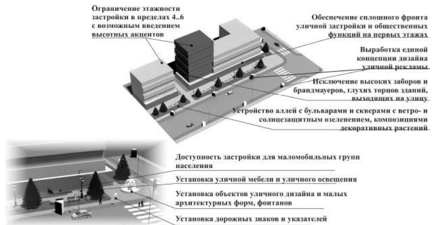
Рис. 152. Мероприятия к реализации приёма формирования благоустроенной среды субцентра (архитектурные аспекты – схемы авторов)
